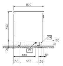
Electrical inlet (power) EQ Equipotential screw
